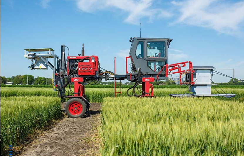
Багатофункціональна машина називається «ФеноТрекер», на відміну від звичайних машин агрегат обладнано моніторинговим устаткуванням, що допомагає науковцям стежити за розвитком посівів.
